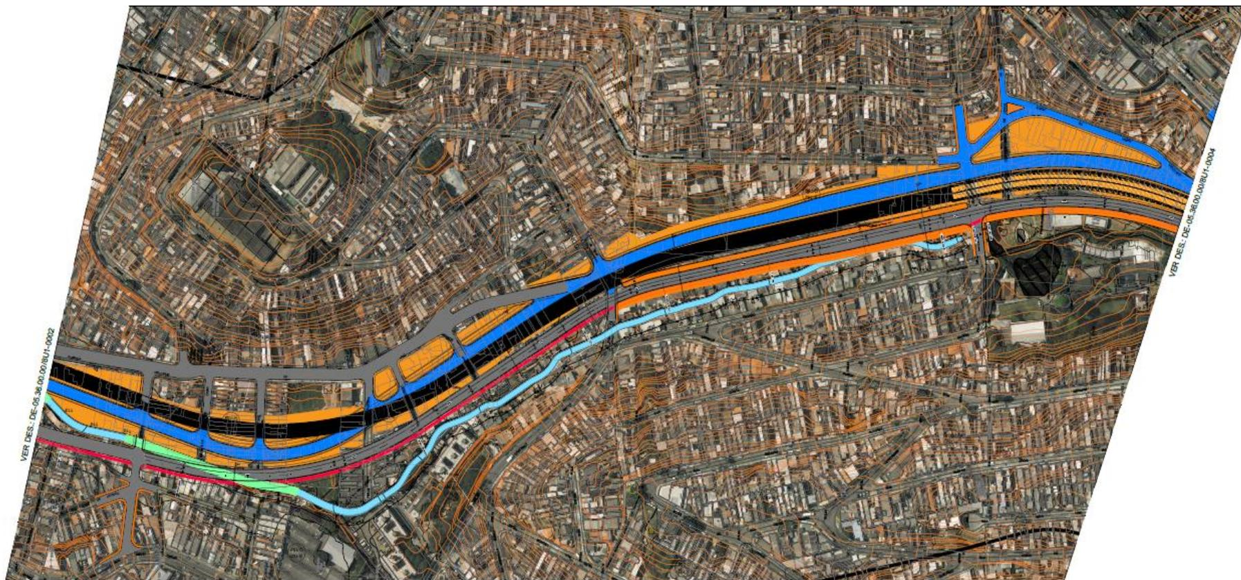
**Figura 3.5-19:** Trecho da extensão na Linha 5 Lilás próximo ao Hospital M Boi Mirim. O polígono laranja representa desapropriação, inclusive do futuro terminal de ônibus, em frente ao terminal Jd. Ângela já existente. A linha preta representa o segmento subterrâneo do metrorviário. Em azul escuro, as intervenções e melhorias viárias do binário (Alternativa 5).
