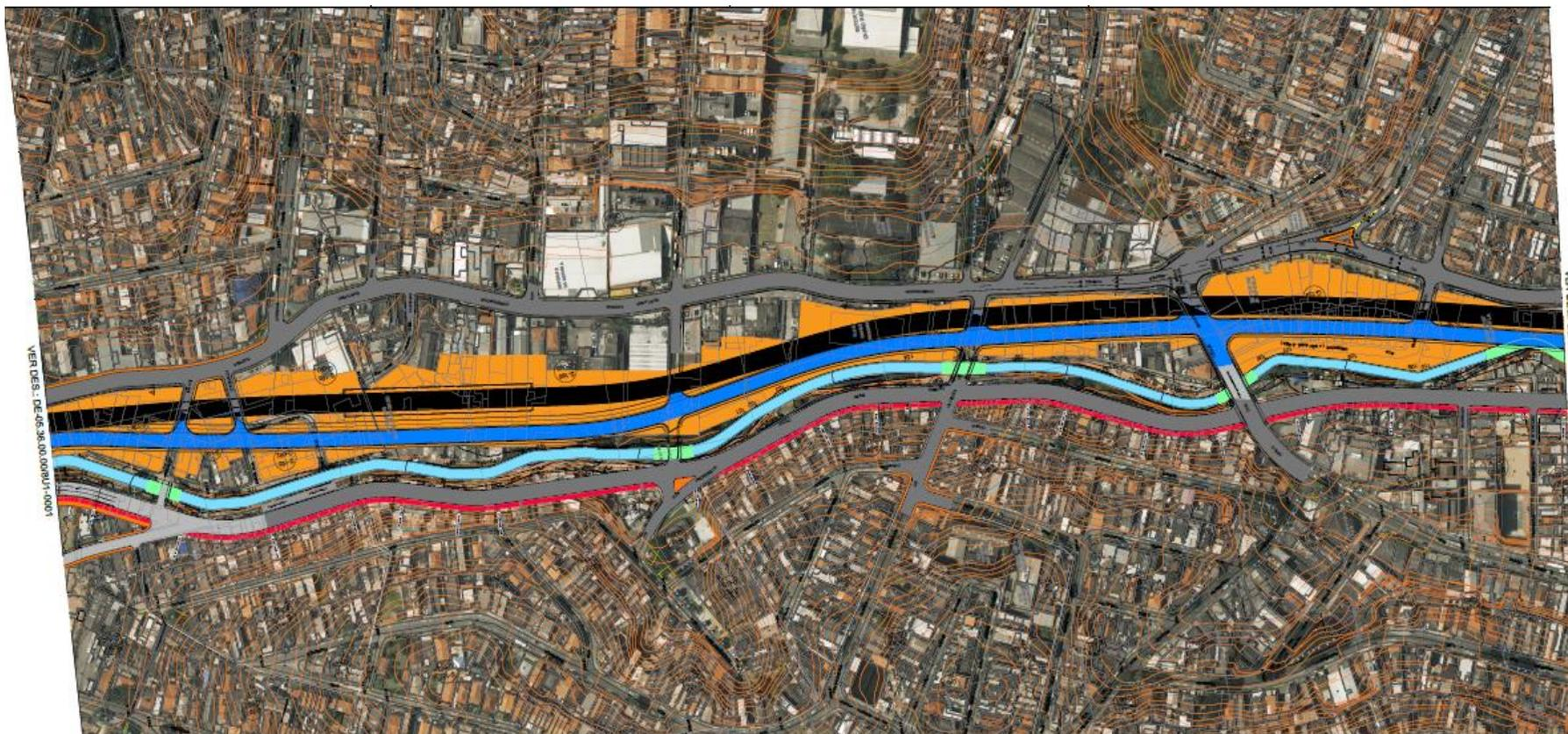
**Figura 3.5-18:** Trecho com a extensão da Linha 5 – Lilás do Metrô. O polígono laranja representa desapropriação. Em preto, a linha metroviária em elevado; em azul escuro, a pista norte do binário; em cinza, a pista sul do binário, a ser licenciada pela PMSP (Alternativa 5).
